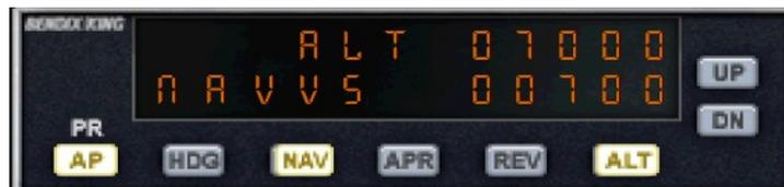
Le tableau du pilote automatique montre le témoin NAV allumé, le GPS reprend le cours normal du vol.
