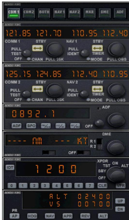
La radio NAV1 est réglée sur la fréquence du localizer de Caen (CN – 110.95).
